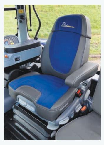
ventilazione per rinfrescarlo ed eliminare l'umidità, questo sedile è perfetto per gli operatori che trascorrono molte ore alla guida del trattore. Il rivestimento del sedile è in pelle di colore blu e grigio.
