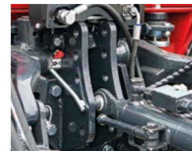
ATTACCO 3° PUNTO RIALZATO Per una geometria del sollevamento favorevole alla regolazione delle attrezzature.
