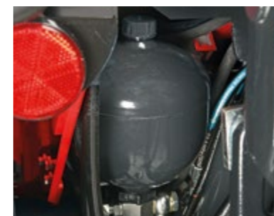
DUMPING compensa le sollecitazioni trasmesse dagli attrezzi portati, aumentando il comfort e contribuendo a preservare la macchina e il conducente da potenziali danni.
