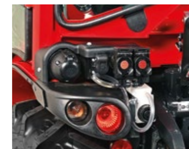
INNESTI RAPIDI POSTERIORI Impianto idraulico modulare con allestimento massimo fino a 11 innesti idraulici suddivisi in mandate continue, doppi effetti e ritorni liberi. Tutte le connessioni sono servite da tubi idraulici a sezione maggiorata per ridurre le perdite di carico e quindi migliorare l'efficienza dell'impianto.
