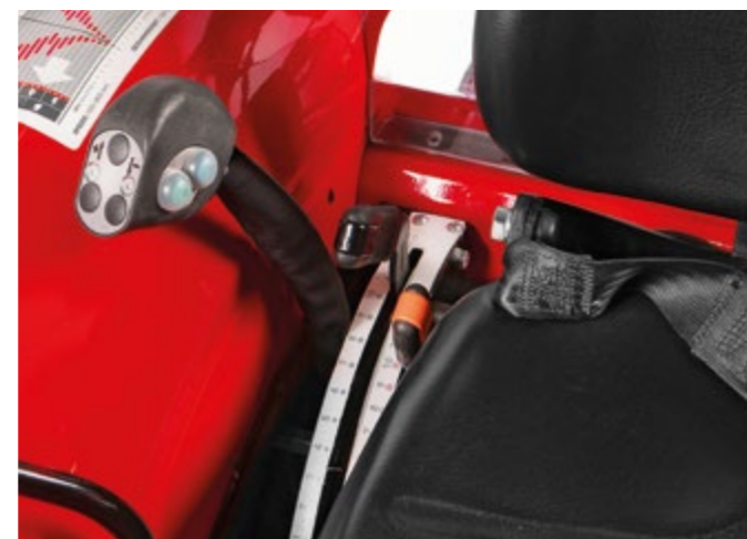
SOLLEVAMENTO A POSIZIONE E SFORZO CONTROLLATO* Dispositivo per la gestione ottimale dell'attrezzatura, sia nella posizione che nello sforzo, in modo da garantire precisione di lavorazione, nella massima aderenza e trazione a terra del trattore.
