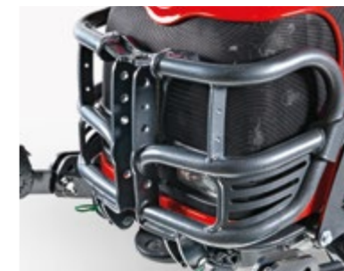
BULLBAR Elemento in tubolare d'acciaio a salvaguardia della carrozzeria; integra l'attacco del terzo punto nella configurazione con il sollevatore ant.
