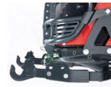
SOLLEVATORE ANTERIORE Dispositivo ausiliario con braccia regolabili e agganci rapidi completo di bullbar. Il sollevatore anteriore permette le lavorazioni in combinata con le attrezzature posteriori.
