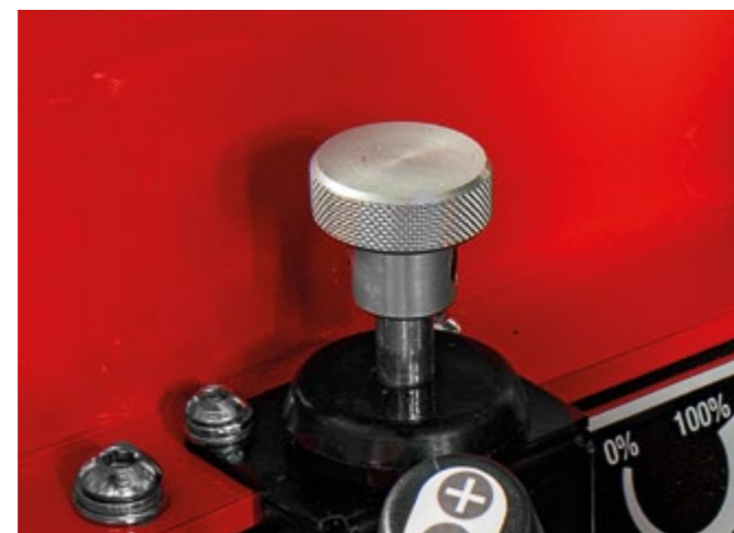
REGOLATORE DI PORTATA Consente la regolazione della portata idraulica da 0 a 50 l/min per gli innesti idraulici con la funzione di mandata continua.
