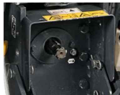
PRESA DI FORZA Cambio con PTO post. 540/1000 giri/min
