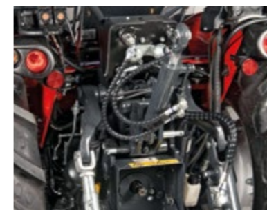
TIRANTE IDRAULICO E TERZO PUNTO Ottimizza il posizionamento e l'inclinazione delle attrezzature.
