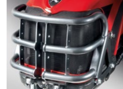
BULLBAR Elemento in tubolare d'acciaio a salvaguardia della carrozzeria; integra l'attacco del terzo punto nella configurazione con il sollevatore ant.
