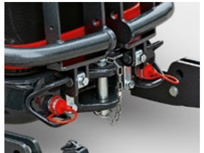
INNESTI RAPIDI ANTERIORI Sollevamento idraulico anteriore completo di attacco a 3 punti + 1 DE anteriore replicato (2 innesti rapidi anteriori).
