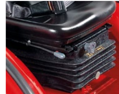
SEDILE PNEUMATICO Molleggio sedile pneumatico a regolazione continua del peso conducente da 50 a 130 Kg e regolazione continua in altezza.
