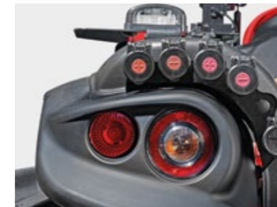
INNESTI RAPIDI POSTERIORI Impianto idraulico elettroproporzionale comandato da joystick "JPM" con doppio sistema di sicurezza operatore e centralina di comando integrata con configurazione e settaggi personalizzabili - 12 innesti rapidi posteriori.
