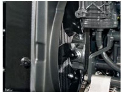
ACS (Air Clean System) Ventola motore con inversione del flusso. Riduce la necessità di pulizia delle griglie frontali, rendendo più costante il raffreddamento del propulsore.
