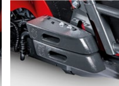
ZAVORRE ANTERIORI Perfettamente integrate nella carrozzeria del trattore, non alterano il passo e l'ingombro del trattore.
