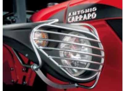
GRIGLIE FARI A protezione della fanaleria ne salvaguardano l'integrità, arricchendo esteticamente la carrozzeria.
