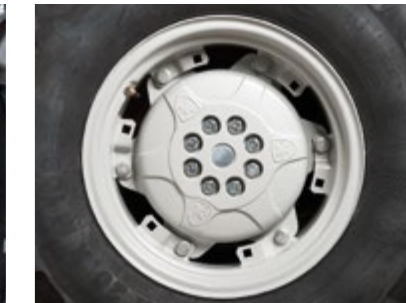
FLANGE IN GHISA POSTERIORE Flange in ghisa che incrementano il peso posteriore del trattore.
