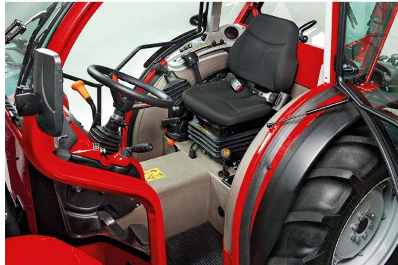
Volante regolabile in altezza e inclinazione, sedile con cinture avvolgibili (anche in versione pneumatica optional) e una piattaforma ampia, contribuiscono a dare al TGF un comfort di tipo automobilistico, alleggerendo la fatica dell'operatore anche durante intense giornate di attività.
