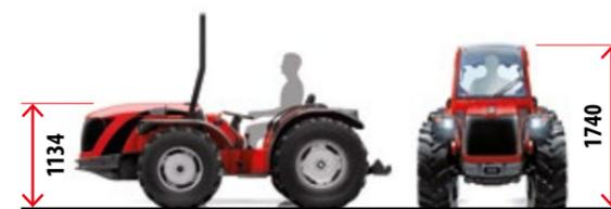
Con TGF l'operatore ha a disposizione la postazione di guida più bassa della categoria: soltanto 1134 mm da terra nella versione con arco abbattibile e 1740 mm in quella cabinata.
