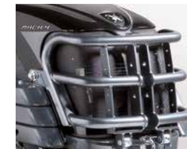
BULLBAR Elemento in tubolare d'acciaio a salvaguardia della carrozzeria; integra l'attacco del terzo punto nella configurazione con il sollevatore ant.
