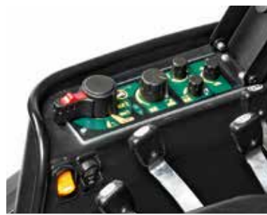
SOLLEVAMENTO ELETTRONICO Sollevamento elettronico a posizione e sforzo controllato con damping per trasferimento su strada.
