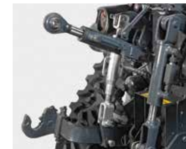
TIRANTE VERTICALE E TERZO PUNTO IDRAULICO Ottimizza il posizionamento e l'inclinazione delle attrezzature.
