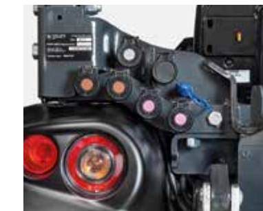
INNESTI RAPIDI POSTERIORI Impianto idraulico elettroproporzionale comandato da joystick "JMC" con doppio sistema di sicurezza operatore e centralina di comando integrata con configurazione e settaggi personalizzabili - 12 innesti rapidi posteriori - Comandi esterni sollevatore.
