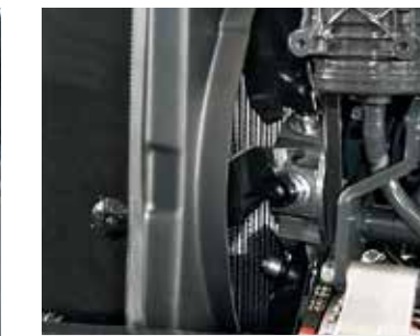
ACS (Air Clean System) Ventola motore con inversione del flusso. Riduce la necessità di pulizia delle griglie frontali, rendendo più costante il raffreddamento del propulsore.
