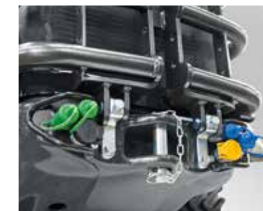
INNESTI RAPIDI ANTERIORI Sollevamento anteriore > 6 innesti replicati da posteriore di cui 2 doppi effetti + 1 mandata continua regolabile elettronicamente e 1 semplice effetto.
