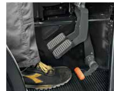
FRENI STERZANTI Per ridurre ulteriormente il raggio di sterzata sono stati introdotti i freni sterzanti.
