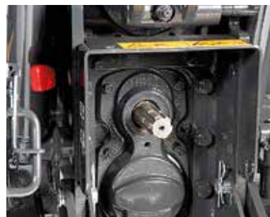
PRESA DI FORZA • Cambio con PTO post. 540/1000 giri/min • Cambio con PTO post. 540/540S giri/min
