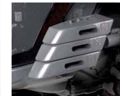
ZAVORRE ANTERIORI Perfettamente integrate nella carrozzeria del trattore, non alterano il passo e l'ingombro del trattore.
