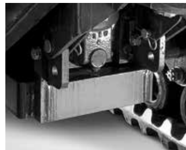
ZAVORRA DI BILANCIAMENTO Zavorra supplementare per un ottimale bilanciamento del mezzo.
