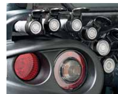
INNESTI RAPIDI POSTERIORI A FACCIA PIANA Facilità di innesto; nessun versamento di olio e maggior pulizia.
