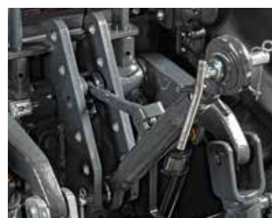
ATTACCO 3° PUNTO RIALZATO Per una geometria del sollevamento favorevole alla regolazione delle attrezzature.
