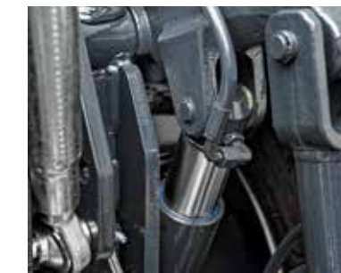
SOSPENSIONE IDRAULICA Sospensione idraulica sul sollevatore posteriore UNIFLEX.
